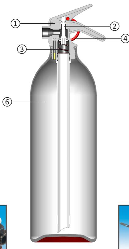
① Der aus Acetalharz hergestellte Ventilblock sorgt für vollständigen Korrosionsschutz.
